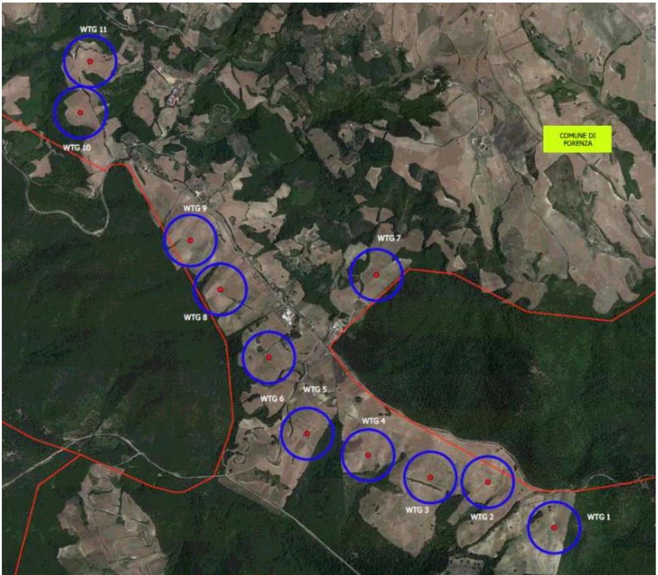
**Figura 1 – Layout di progetto con indicazione della gittata massima della pala in caso di distacco**
