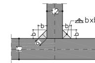
i cordoni d'angolo che uniscono due laminati di spessore  $t_1$  e  $t_2$  con  $t_2 \leq t_1$ , devono avere il lato "b" soddisfacente le condizioni di calcolo e, di regola, le seguenti limitazioni:
