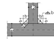
i cordoni d'angolo che uniscono due laminati di spessore  $t_1$  e  $t_2$  con  $t_2 \leq t_1$ , devono avere il lato "b" soddisfacente le condizioni di calcolo e, di regola, le seguenti limitazioni:
