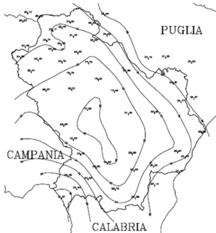
**Figura 13: Isolinee dell'esponente n (da Claps e Straziuso, 1996).**
