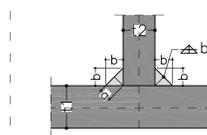
i cordoni d'angolo che uniscono due laminati di spessore  $t_1$  e  $t_2$  con  $t_2 \leq t_1$ , devono avere il lato "b" soddisfacente le condizioni di calcolo e, di regola, le seguenti limitazioni:
