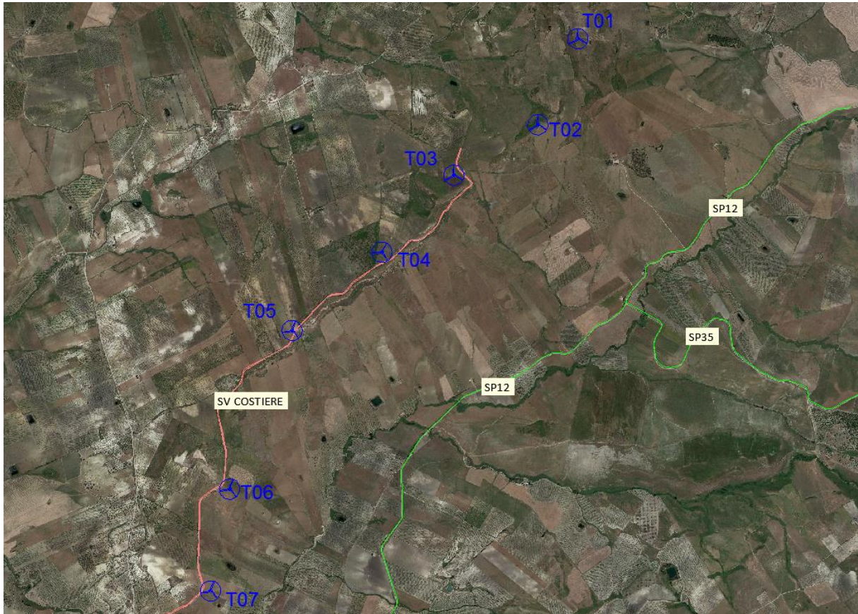
Figura 18 – Schema layout con indicazione delle torri esistenti nei pressi del sito d’installazione (in arancione) e degli assi viari esistenti che verranno adeguati per la realizzazione del campo eolico.
