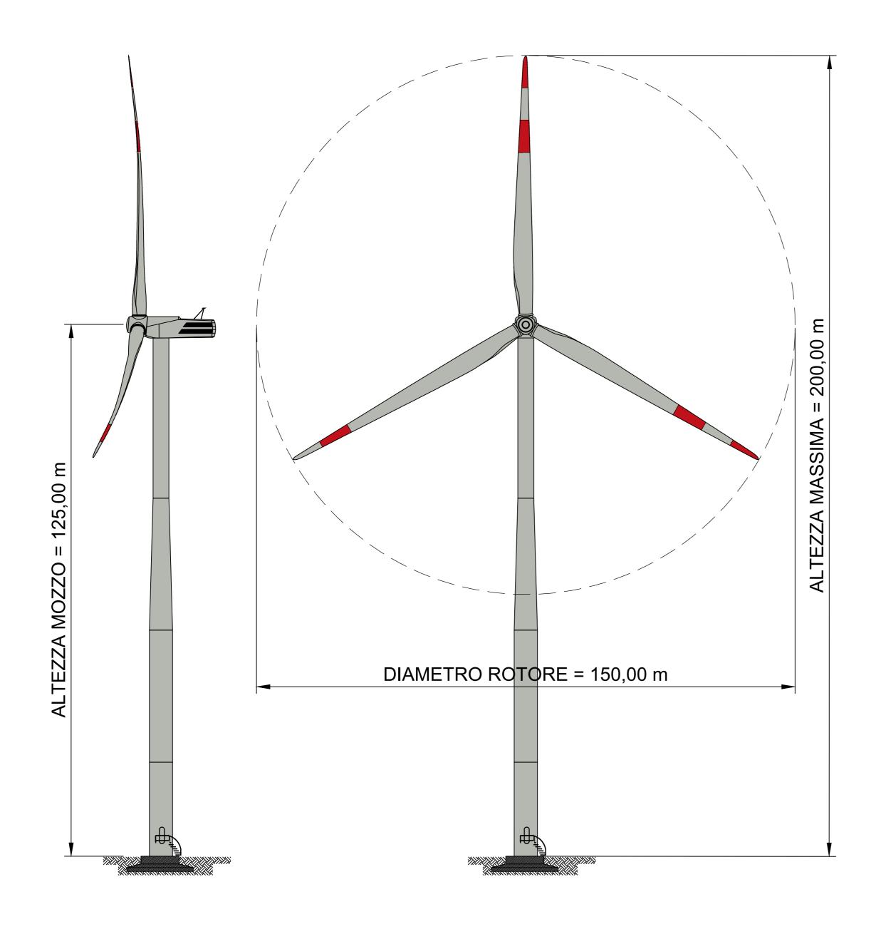
AEROGENERATORI CON SEGNALAZIONE CROMATICA E LUMINOSA DI TIPO A COME DA SPECIFICHE PER LA SICUREZZA DEL VOLO A BASSA QUOTA
