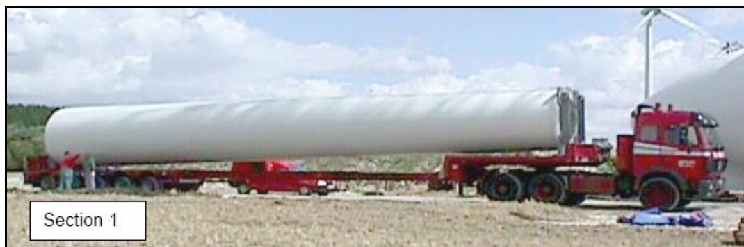
Figura 12: trasporto della sezione della torre
