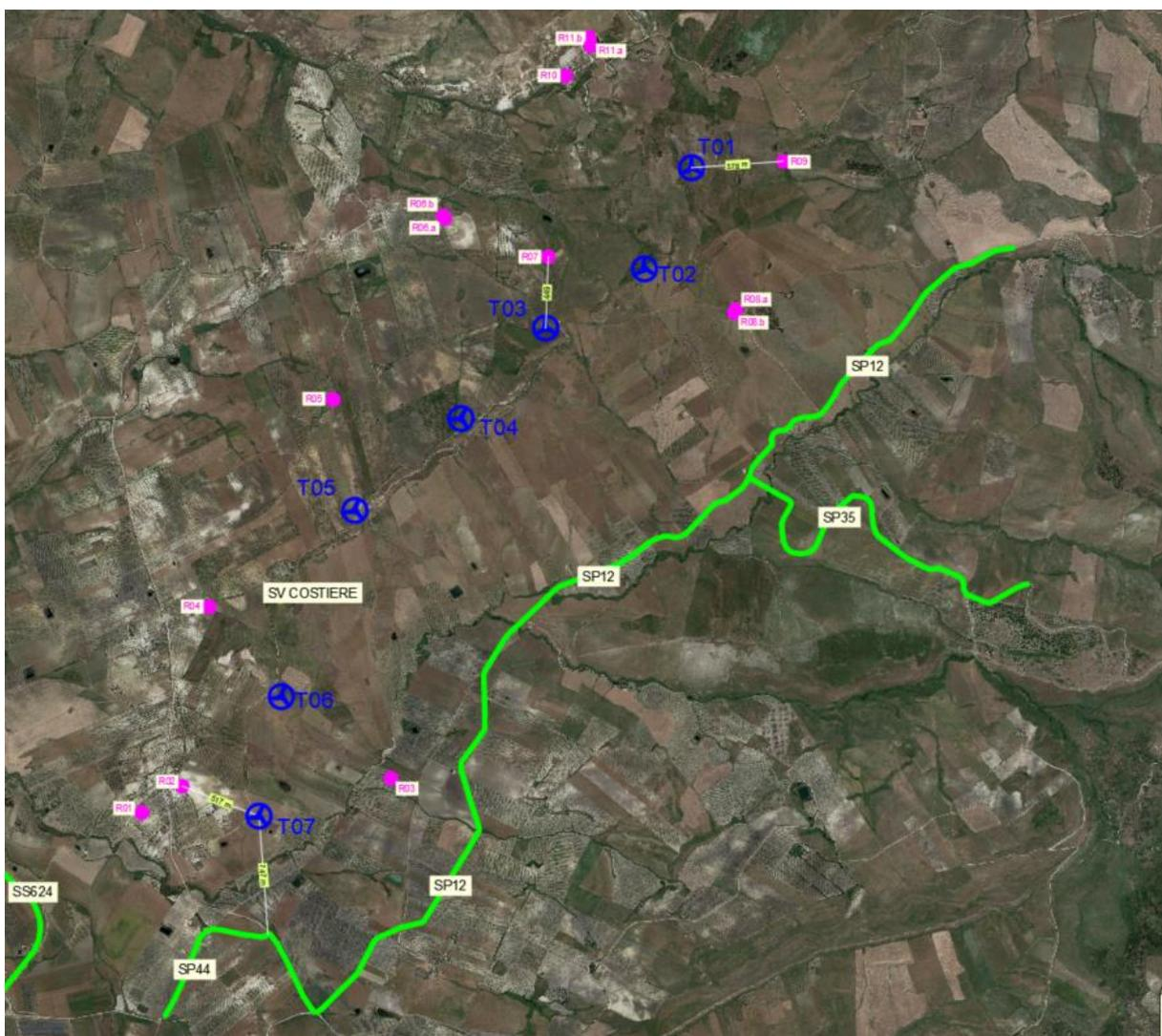
**Figura 3:** Distanze minime degli aerogeneratori dalle strade principali e dai recettori
