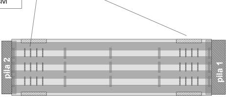
base della pila predisposta con demolizioni pareti e perforazione fori da mina nelle costole, nelle quali realizzare il cuneo di ribaltamento con esplosivi
