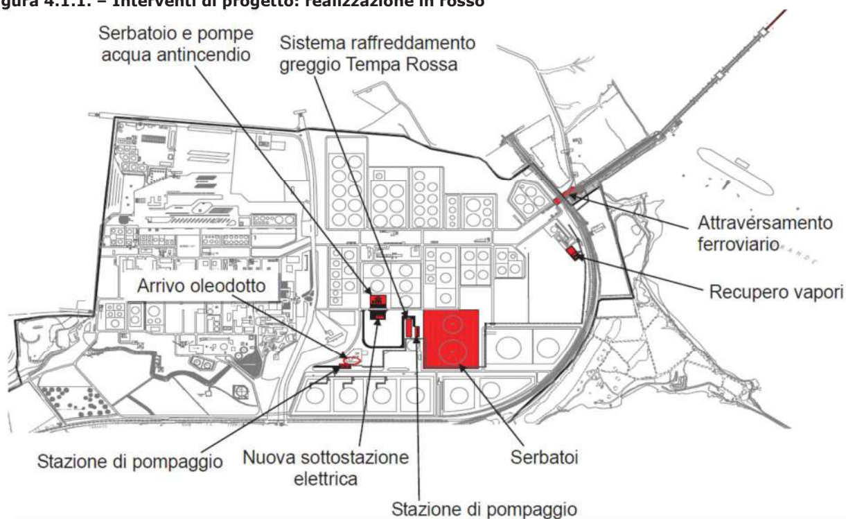
Figura 4.1.1. – Interventi di progetto: realizzazione in rosso
