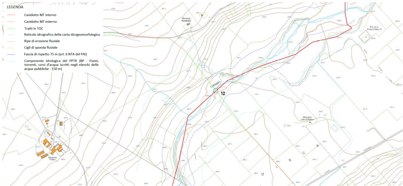
Attraversamento in T.O.C. del Torrente Calaggio
