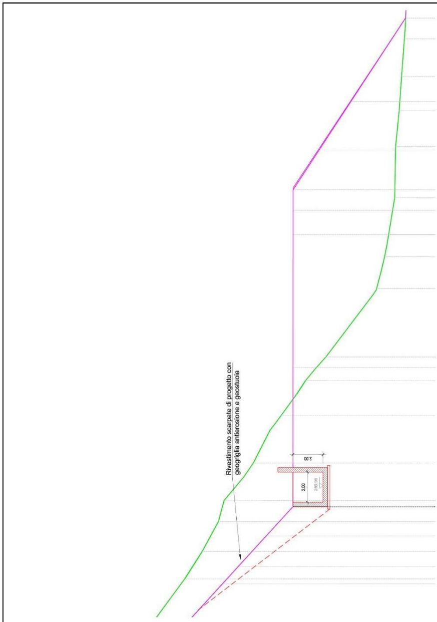
Figura 7-5. Canale di guardia Cantiere – Sezione trasversale
