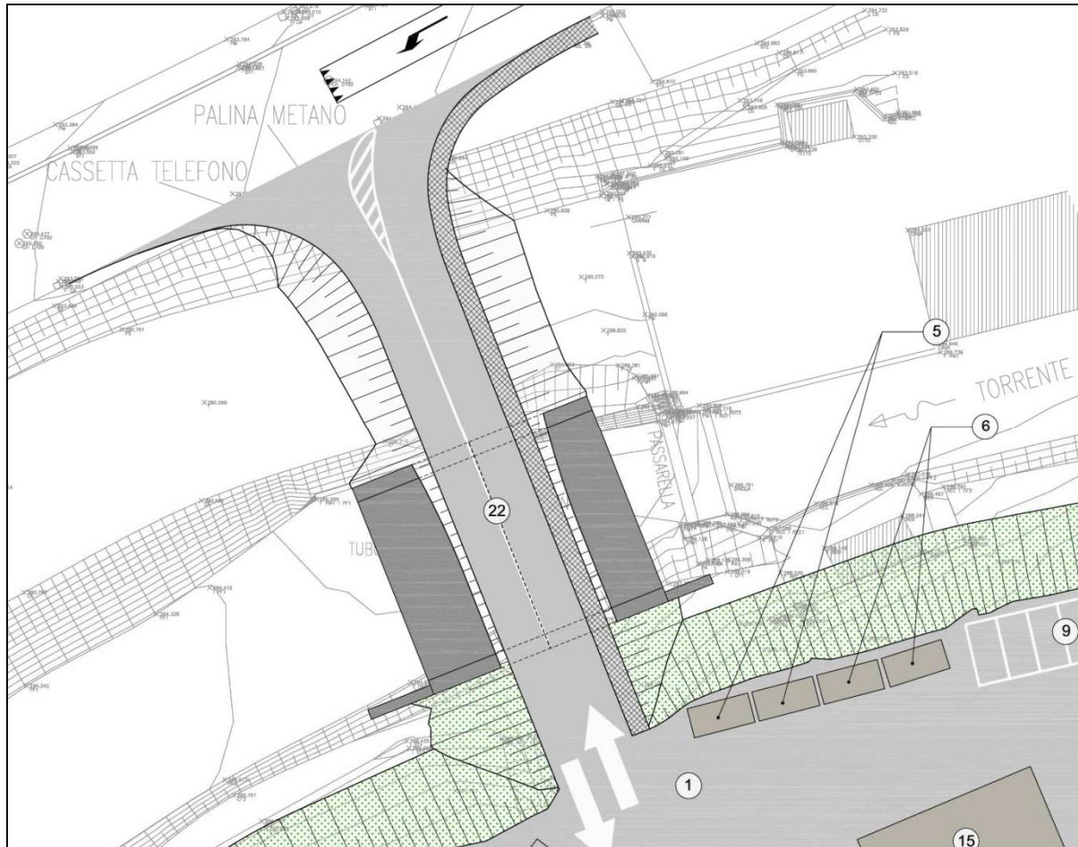
Figura 6-2. Manufatto di accesso Cantiere – Planimetria progetto
