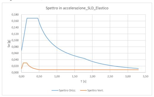
Figura 6.7: Spettro elastico SLD- orizzontale e verticale
