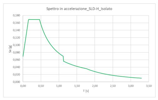
Figura 6.10: Spettro orizzontale Isolato SLD
