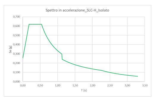
Figura 6.12: Spettro orizzontale Isolato SLC
