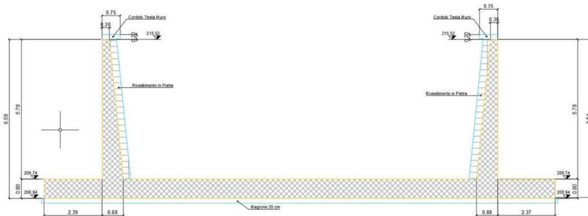
Figura 10-8: Muro OP3-007/008– Sezione trasversale
