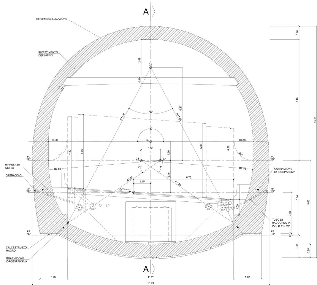
SEZIONE TIPO GALLERIA NATURALE TRATTA NORD - SEZIONE B0v e B2v
