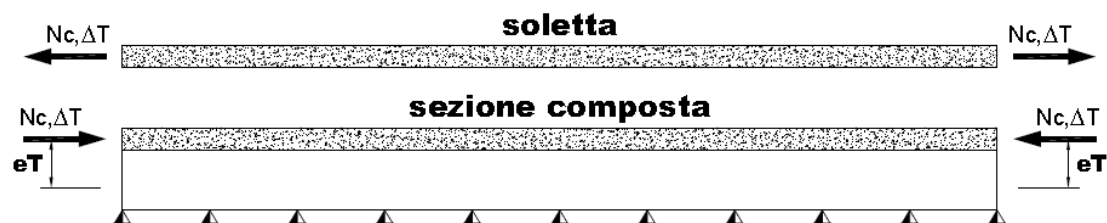
Figura 2-3 - Azioni statiche equivalenti alla variazione termica negativa
