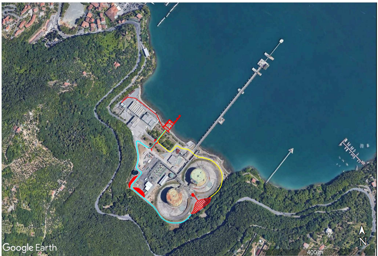
Figura 8 - Tracciato delle autocisterne/isocontainer all'interno dell'impianto:
