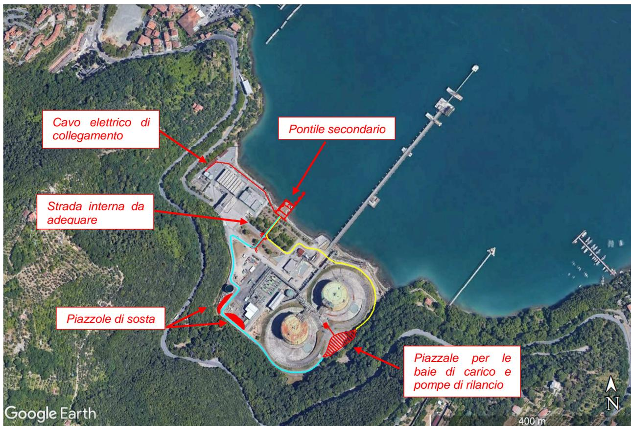
Fig. 6.1 - Stralcio planimetrico dell'impianto con individuazione delle aree di intervento in rosso. La linea azzurra (—) rappresenta il percorso della autocisterne/isocontainer dal pontile secondario alle baie di carico, la linea gialla (—) il percorso dalle baie di carico al pontile secondario (Fonte: Google earth)
