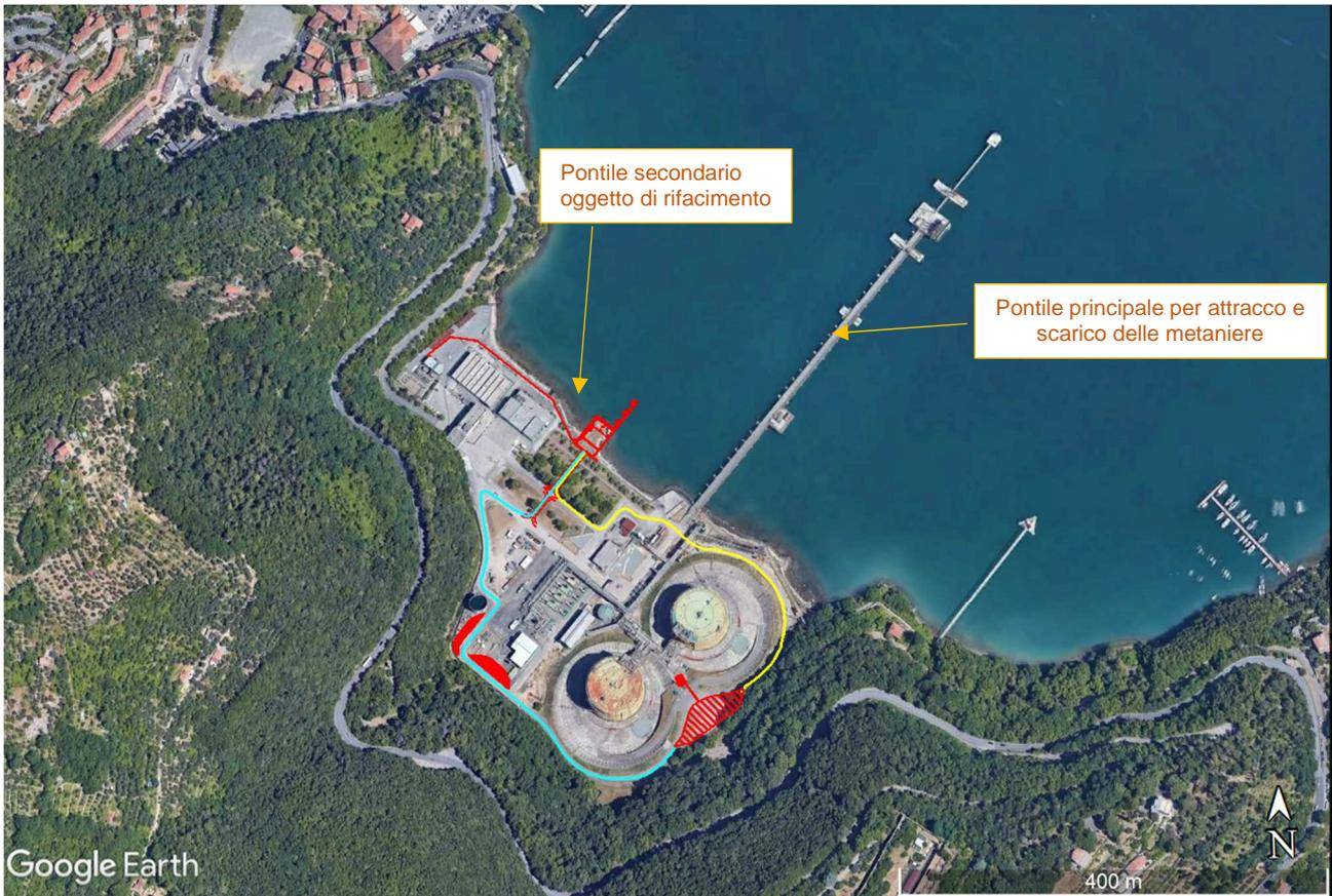
**Figura 1.2: posizione del pontile secondario presso il Terminale e stralcio planimetrico dell'impianto con individuazione delle aree di intervento in rosso. La linea azzurra (—) rappresenta il percorso della autocisterne/isocontainer dal pontile secondario alle baie di carico, la linea gialla (—) il percorso dalle baie di carico al pontile secondario (Fonte: Google earth)**
