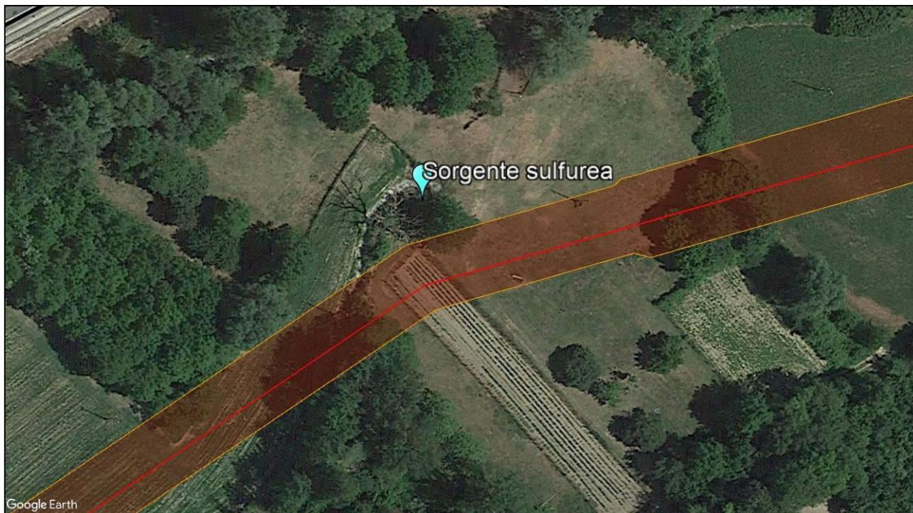
**Figura 6.8:** configurazione spaziale tra l'area di occupazione lavori e la sorgente sulfurea all'interno della ZSC IT6020012. Si noti anche il restringimento della pista di lavoro all'interno del sito Natura 2000, al fine di ridurre le interazioni superficiali con gli ambienti di interesse conservazionistico.
