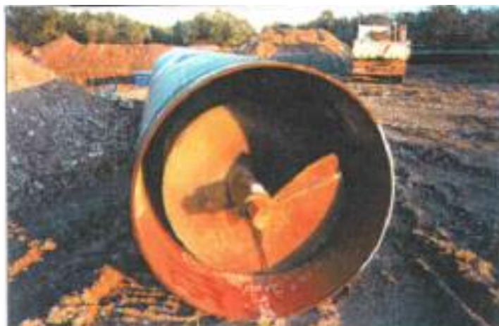
Fig. 2.5 - Coclea per trivella spingitubo.
