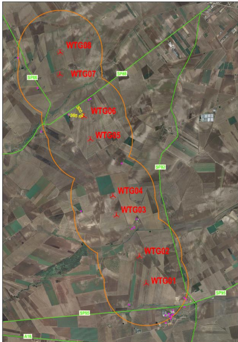
Figura 4 – Inquadramento Alternativa1 rispetto ai recettori ricadenti nel buffer di 1000m (in arancione) con indicazione delle distanze minime dai recettori (in magenta) e dalla viabilità principale (in verde)
