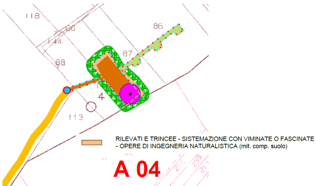
Figura 3 aree oggetto di sistemazione con viminate o fascinate od altre specifiche opere di ingegneria naturalistica (Tavola 22 Mitigazioni su catastale)
