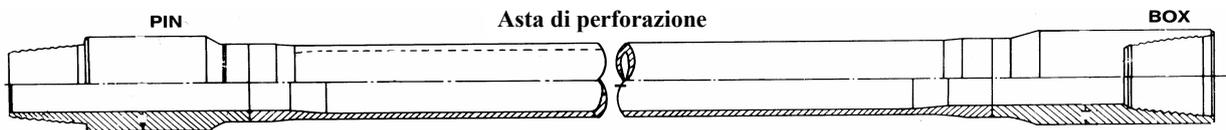
**Fig. 2.3.1/5 – Aste di perforazione**
