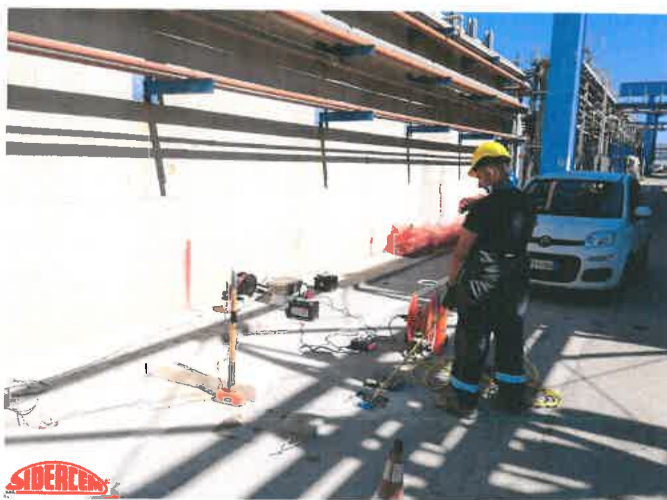
Figura 4.2.a: Prospezione sismica Down-hole
