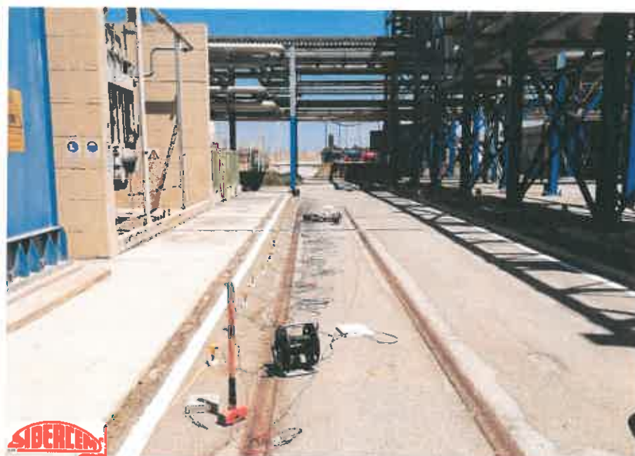
Figura 4.1.a: Prospezione sismica MASW
