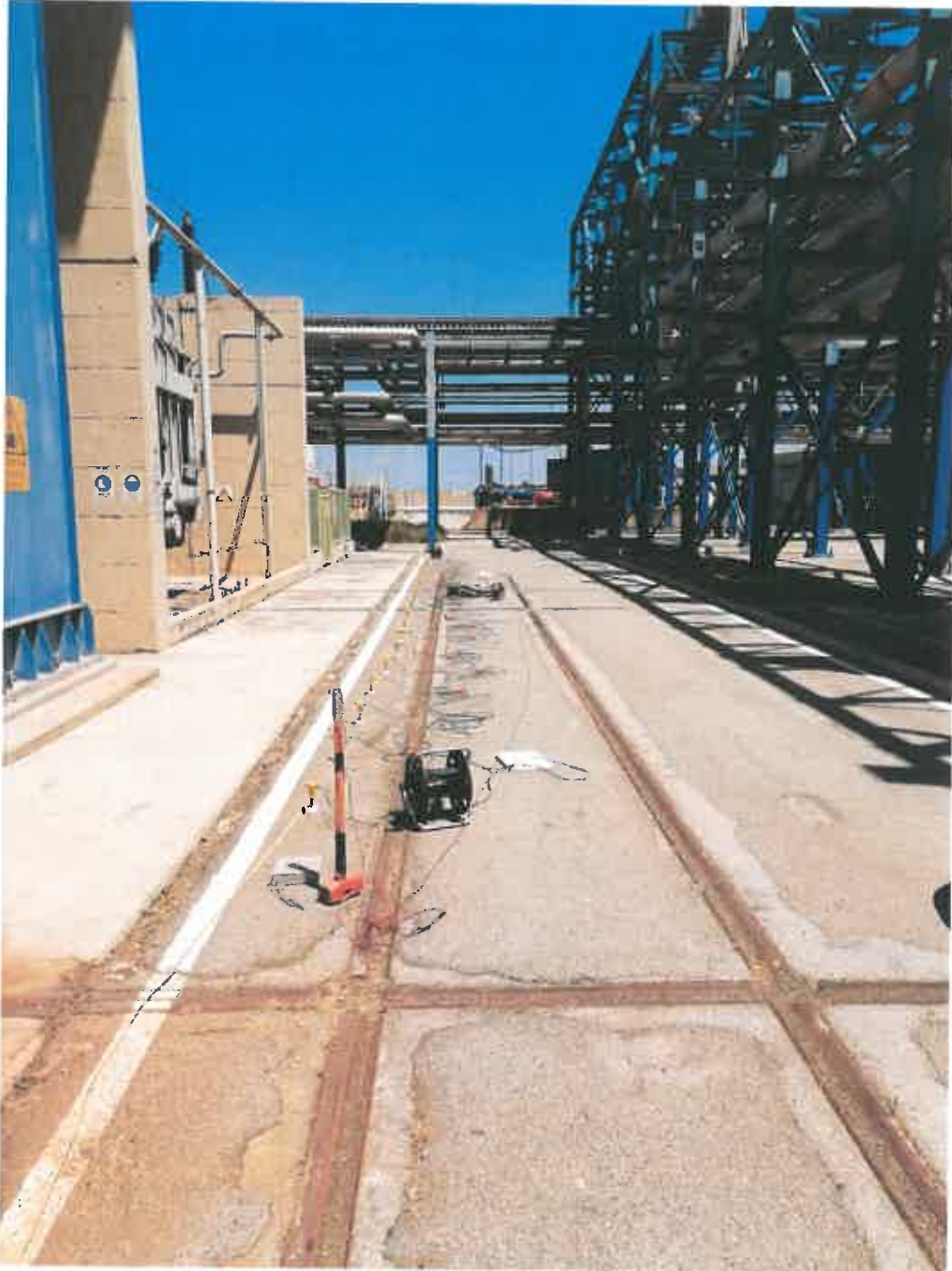
Foto n.4.0- Prova M.A.S.W. 1 Stabilimento Termini Imerese
