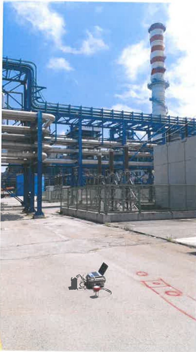
Foto n.1-Stazione di Acquisizione microtremore
