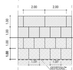
\*GEOTESSILE NON TESSUTO TERMOSALDATO IN FIBRA DI POLIPROPILENE A FILO CONTINUO, IMPIEGATO COME STRATO DI SEPARAZIONE E FILTRAZIONE
