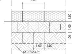
\*GEOTESSILE NON TESSUTO TERMOSALDATO IN FIBRA DI POLIPROPILENE A FILO CONTINUO, IMPIEGATO COME STRATO DI SEPARAZIONE E FILTRAZIONE
