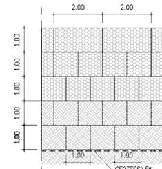
\*GEOTESSILE NON TESSUTO TERMOSALDATO IN FIBRA DI POLIPROPILENE A FILO CONTINUO, IMPIEGATO COME STRATO DI SEPARAZIONE E FILTRAZIONE
