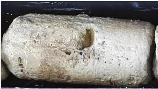
**Figura 8** – Sondaggio S2 – Spezzone di calcare integro.
