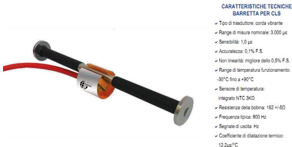
Figura 3. Caratteristiche tecniche e dettaglio delle barrette estensimetriche per calcestruzzo
