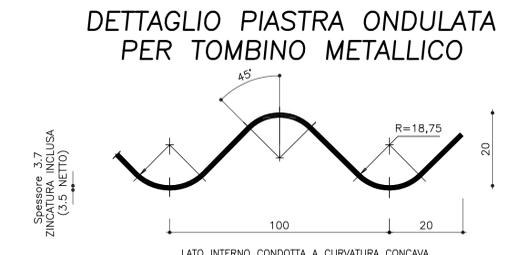
PIASTRE PER "MULTIPLATE" - ONDULAZIONE Dim. mm 100 x 20
