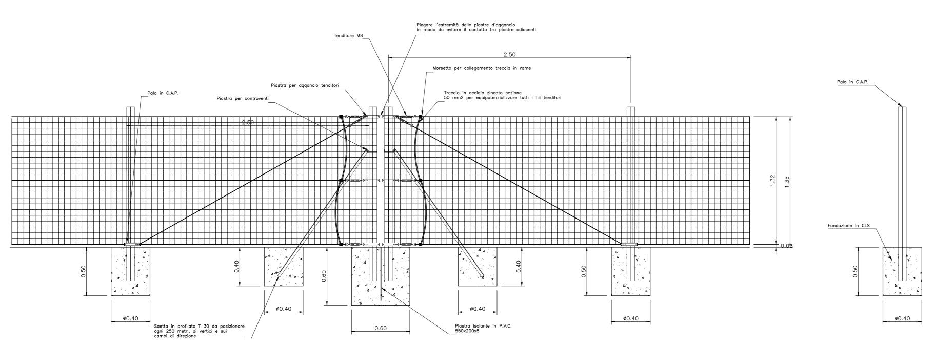
Doppio palo in C.A.P. con saette e isolamento elettrico da predisporre ogni 250 metri
