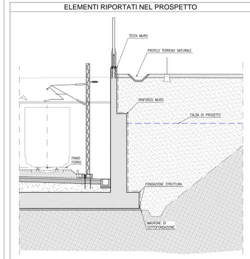
PROSPETTO CARPENTERIA MURO TR15
