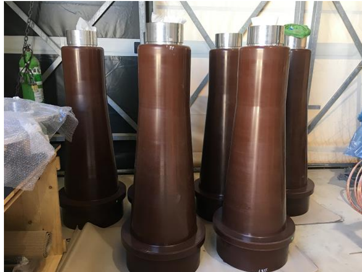
Figura 53 – Particolare terminale cavo
