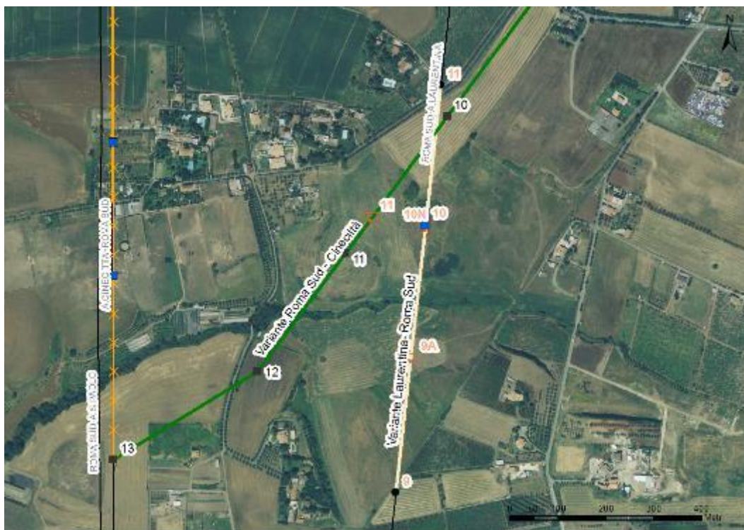
Figura 3-9 - INTERVENTO A) - Linea esistente 150 kV DT “Laurentina- Roma Sud”. In arancione il sostegno 10N che viene spostato in asse linea ed il nuovo sostegno 9A. Per la variante 220 kV “Roma sud- Cinecittà” in arancione il sostegno n. 11 che viene arretrato in asse linea e quelli oggetto di ulteriore ottimizzazione (10 e 12). In nero i sostegni presentati nell’attuale iter autorizzativo o quelli relativi alla linea esistente.
