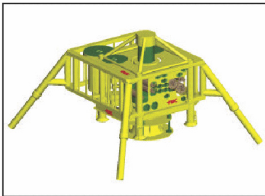
Fig. 4.2/1 – Esempio di Struttura protettiva
