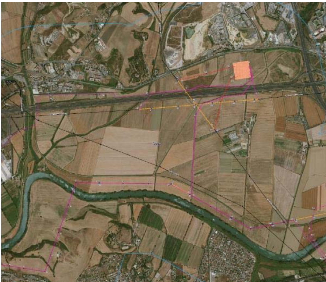
Figura 3-9– Nuova Stazione Elettrica 380/150 kV di Ponte Galeria (II.1) e raccordi aerei a 380 kV (II.2)
