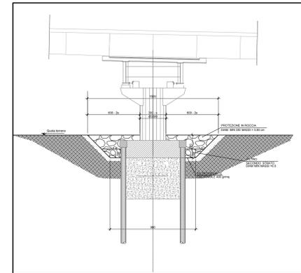
**Sezione longitudinale pile**
