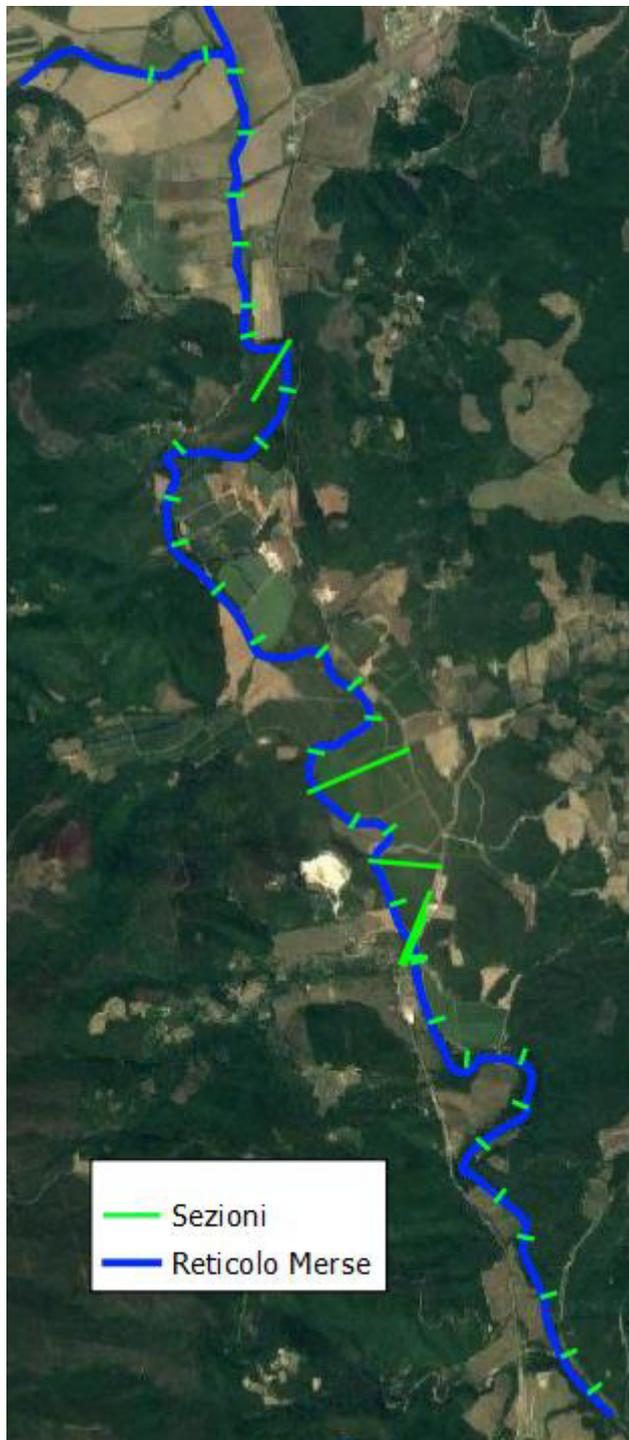
*Figura 5 - Sezioni idrauliche rilevate in sito*
