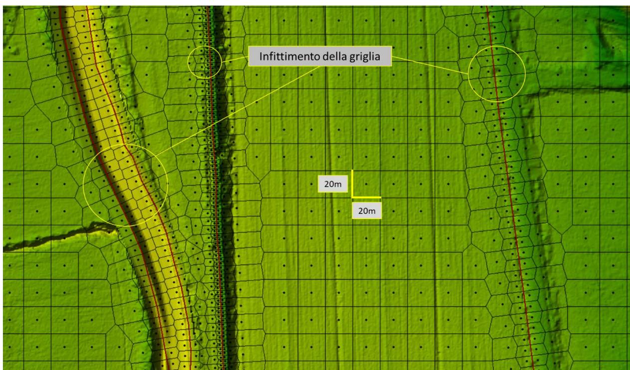
*Figura 9 - Griglia di calcolo del modello bidimensionale: lungo tutto l'alveo e in corrispondenza di argini, rilevati, pile e limiti delle risaie, la griglia è stata infittita per tener conto del brusco cambiamento di quota.*
