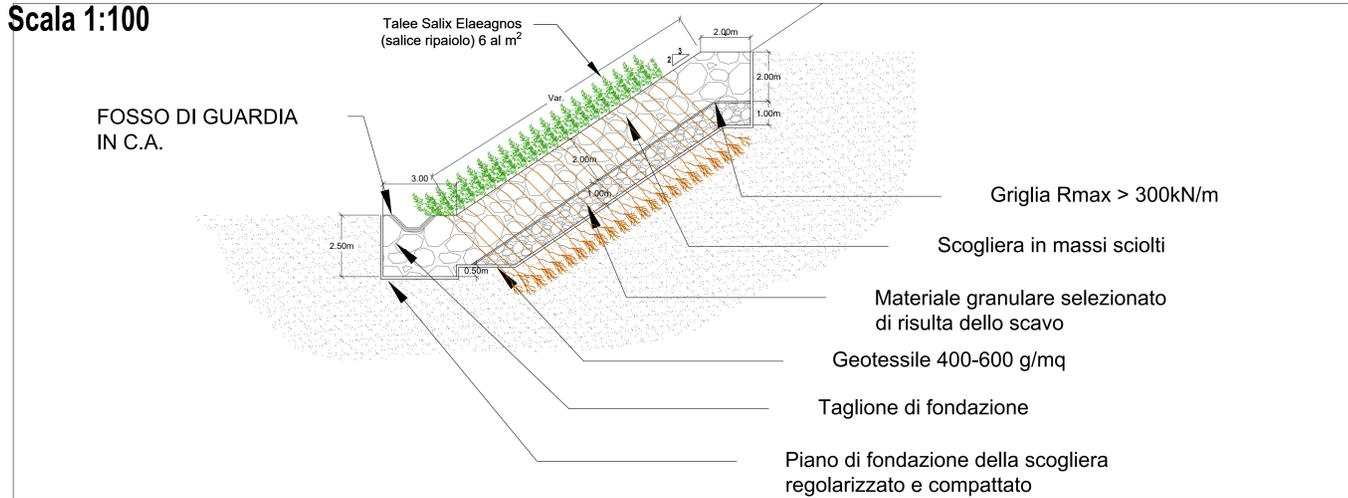
**Sezione tipologica scogliere protezione rilevato km 49+740 e km 49+920**
