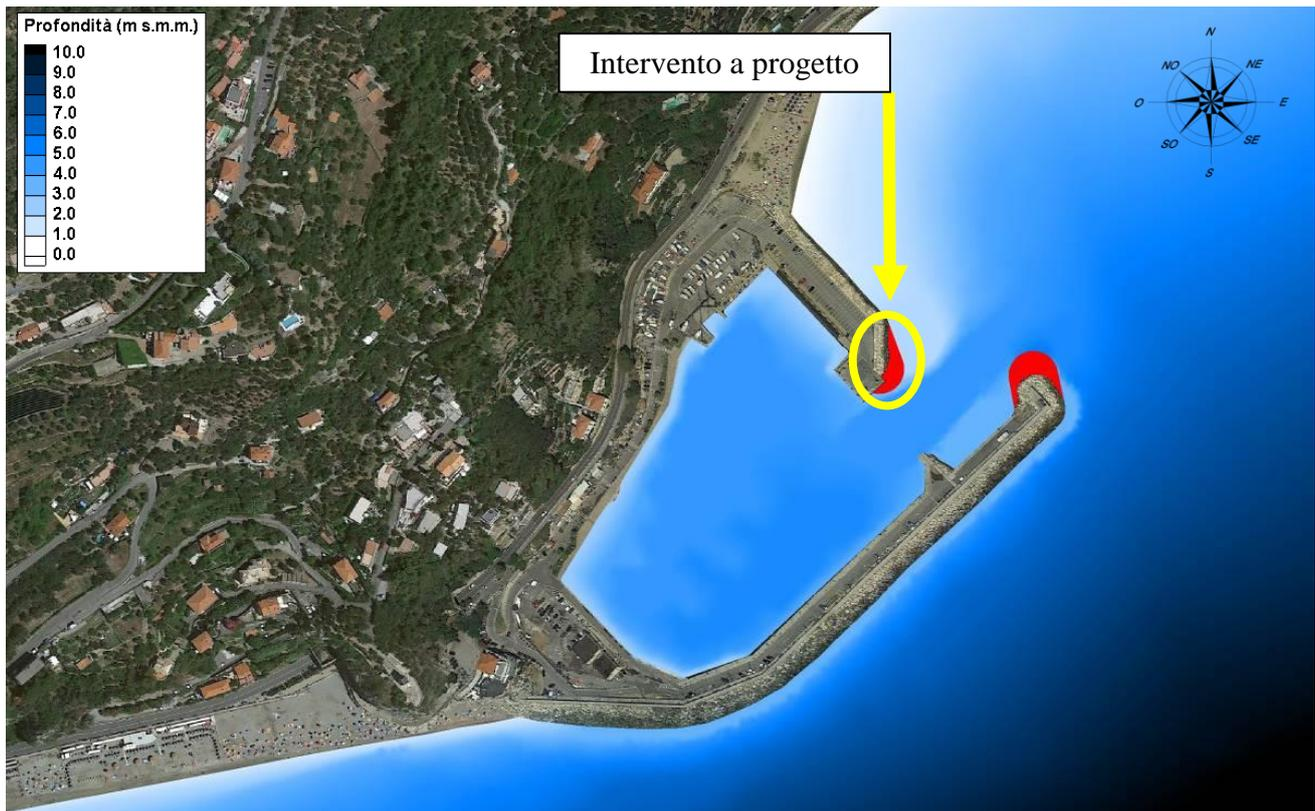
finalizzata alla determinazione di una configurazione atta alla riduzione dell'onda residua all'interno del porto; con questo intervento la situazione si migliora, ma potrà essere condotta ai valori raccomandati da PIANC, positivamente valutati dal Consiglio Superiore dei LLPP, con ulteriori interventi che sono valutati al paragrafo 5 dello stesso Elab. I
