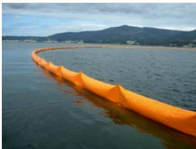
*Figura 29: Esempio di utilizzo di barriera galleggiante antinquinamento (Immagini di proprietà di CSA Distribuzione srl)*
