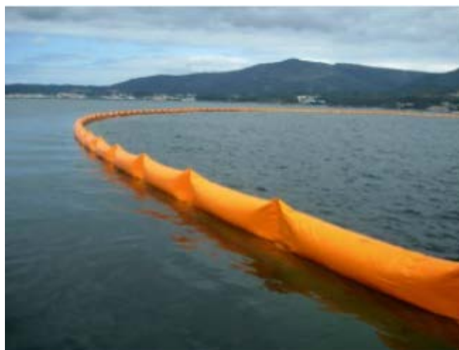
Figura 13: Esempio di utilizzo di barriera galleggiante antinquinamento (Immagini di proprietà di CSA Distribuzione srl)
