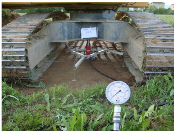
Figura 3.1 Strumentazione di prova e mezzo di contrasto
