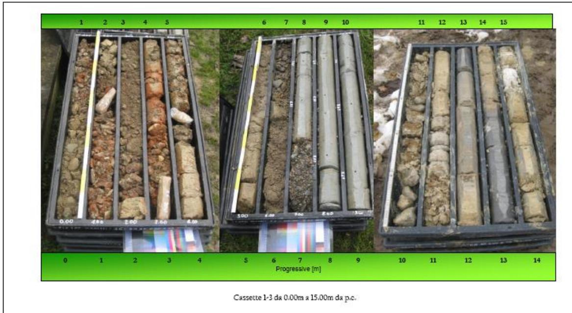
Fig 3.28 – Carote estratte dal sondaggio S3 (da 0 a 15 m dal p.c.)
