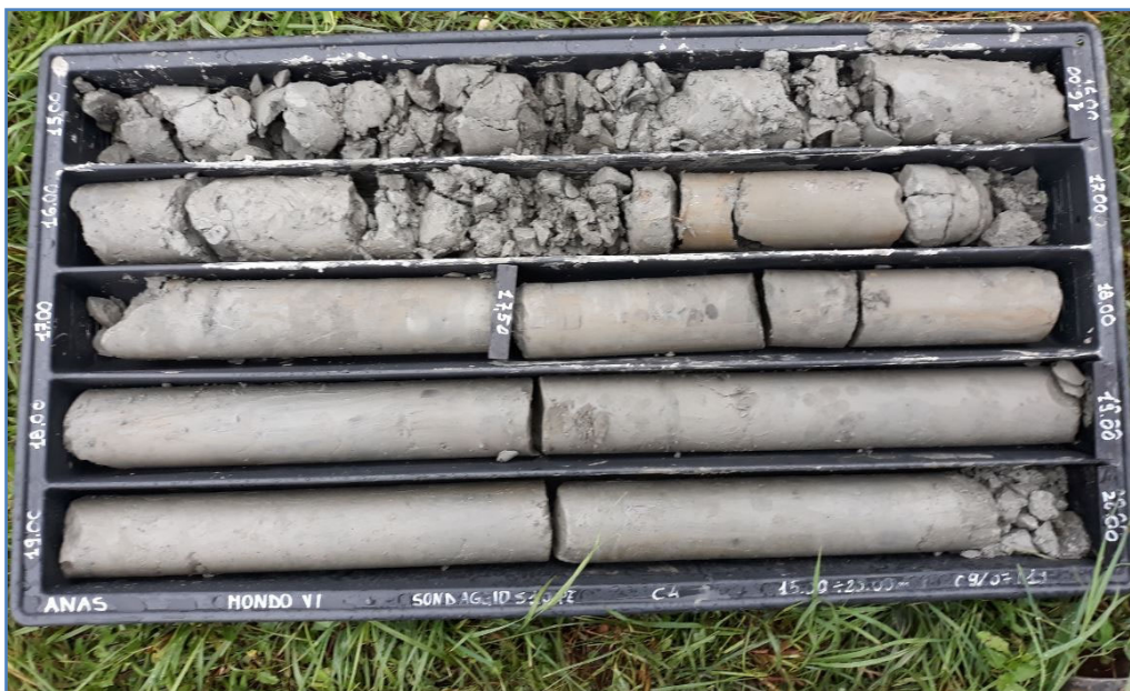
Foto 4.4 Marne (di S Agata Fossili) nel sondaggio S10-Pz fra 10-15 m da p.c.
