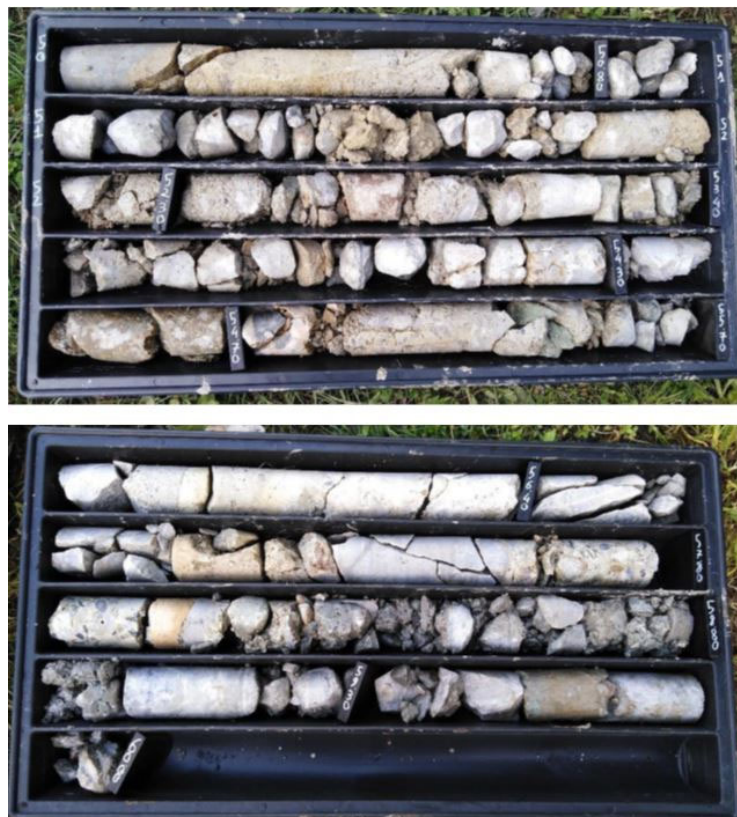
Figura 7.35 Sondaggio S7 fra 50 – 60 m all'altezza della galleria naturale
