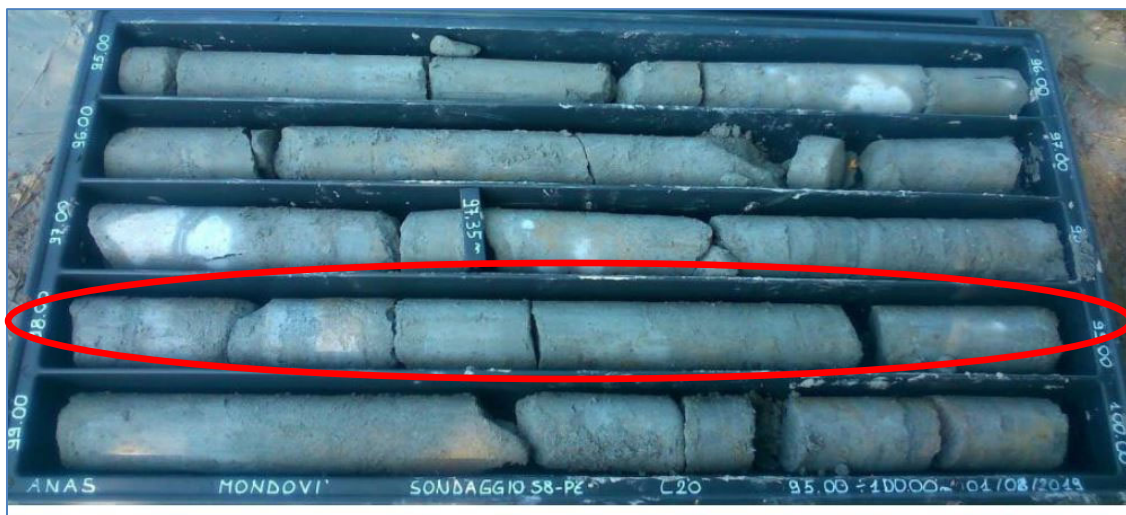
Figura 7.28 Stralcio foto cassetta sondaggio S8 dove fra 98-99 m è stato prelevato il CR1
