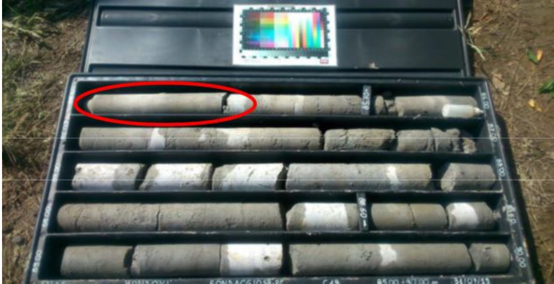
Figura 7.32 Foto cassetta sondaggio S8 dove a 85 m è stata eseguita la prova dilatometrica con risultato anomalo. Facendo riferimento soprattutto alle prove dilatometriche, che si ritengono più rappresentative del comportamento complessivo dell'ammasso roccioso alla scala delle opere, si associa all'ammasso roccioso un modulo elastico di 1.000 -1.100 MPa, valore che trova conferma applicando la relazione che lega la resistenza a compressione semplice della roccia intatta \sigma_{ci} ed il modulo elastico dell'ammasso roccioso contenuta nella già citata pubblicazione (1) di Hoek: E = 200 \times \sigma_{ci} = 200 \times 5,5 = 1.100 \text{ MPa}
