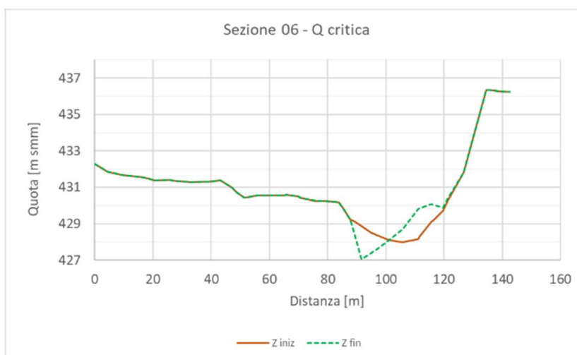
Figura 45 – Sezione 06, andamento del fondo alveo, simulazione Qcritica
