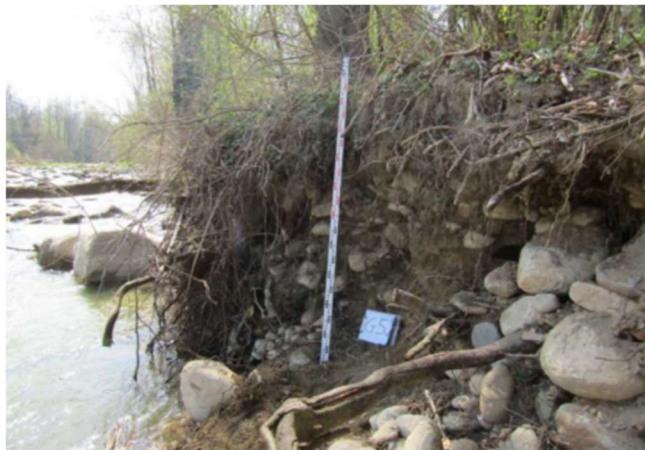
Figura 6 – Sponda sinistra in erosione, posizione G5-bis, in prossimità dell'impalcato di progetto.
