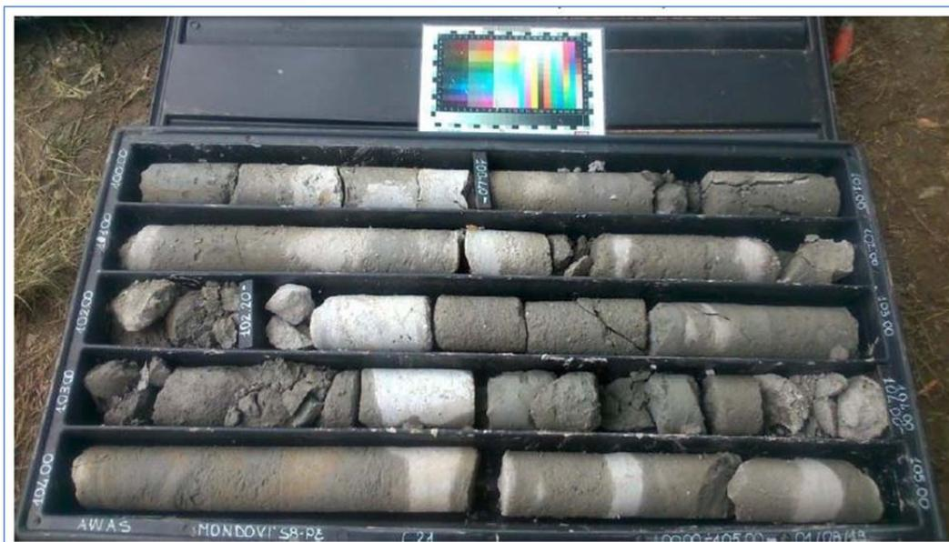
Foto 4.3 Arenarie della F.ne di Lequio nel sondaggio S8 del 2019 fra 100-105 m da p.c.
