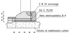
SEZIONE TIPOLOGICA - SEZIONE DI INNESTO STRADA ESISTENTE
