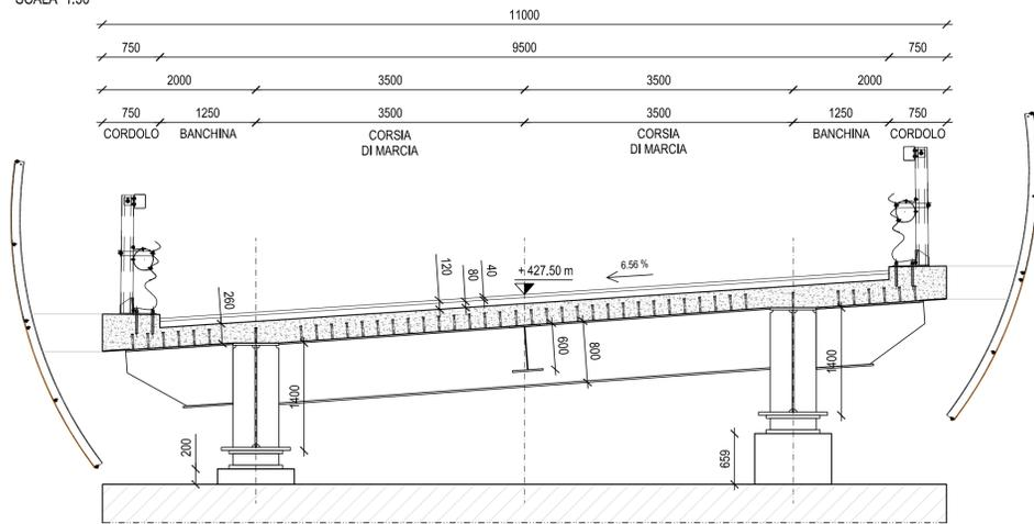
SEZIONE TRASVERSALE - PILA "P1"
