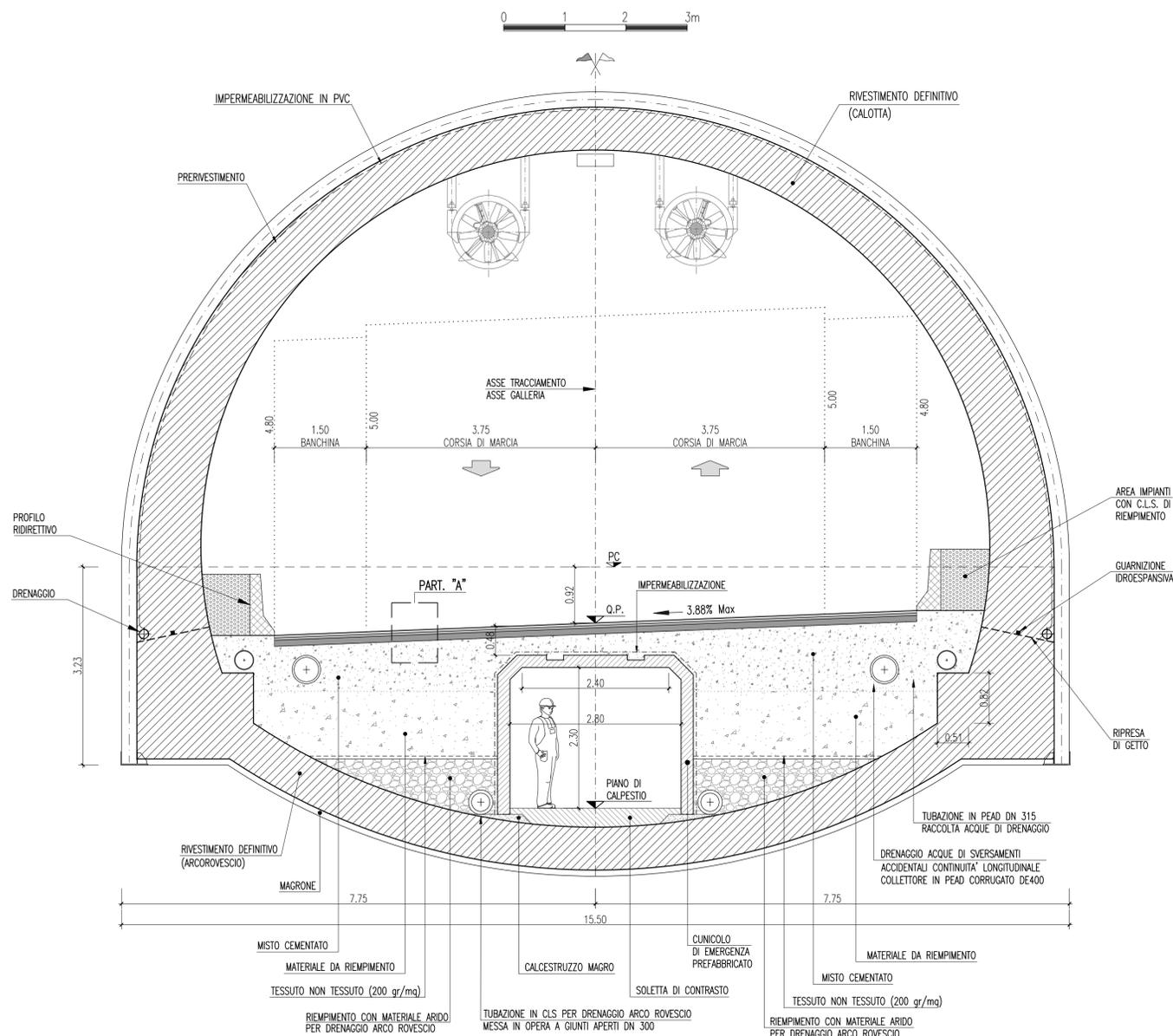
SEZIONE TRASVERSALE – PARTICOLARE "A"
